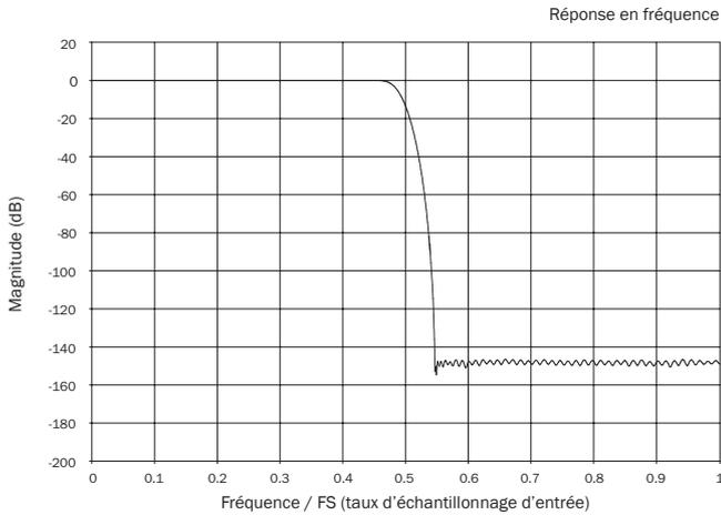
Le filtre de phase minimum est un autre filtre audio qui jouit d'une excellente réputation et qui offre une ondulation encore plus faible dans les bandes passantes et d'arrêt. Contrairement au filtre de phase linéaire, le retard de groupe n'est pas constant ; cependant, le déphasage est faible et l'avantage particulier de ce filtre est que la réponse impulsionnelle ne présente pas de pré-oscillations.
