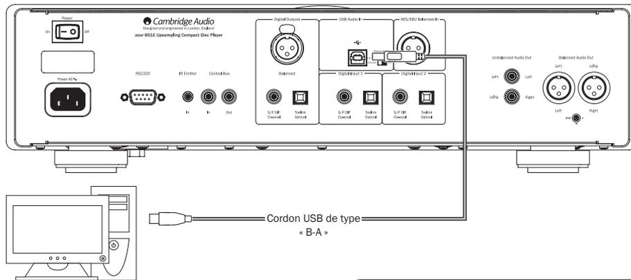
**Réglez toujours le volume au niveau minimum, basculez sur une autre entrée ou éteignez le 851C avant de brancher/débrancher des câbles sur l'entrée USB ou lorsque vous démarrez/arrêtez votre PC/Mac.**
