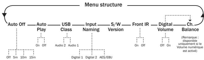
La structure du menu du 851C offre de nombreux paramètres de configuration qui peuvent être ajustés pour satisfaire à la fois aux exigences spécifiques d'installation et aux préférences personnelles. Les paramètres de configuration sont accessibles et modifiables via une interface pilotée par un menu qui utilise l'afficheur du 851C, et via les touches *Menu*, *Sélection*, *Saut* (◀ ▶) et *Arrêt* (■) du panneau avant ou de la télécommande.
